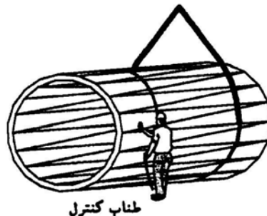
شکل ۲-۷-۸: جابجایی مجموعه لوله‌ها
